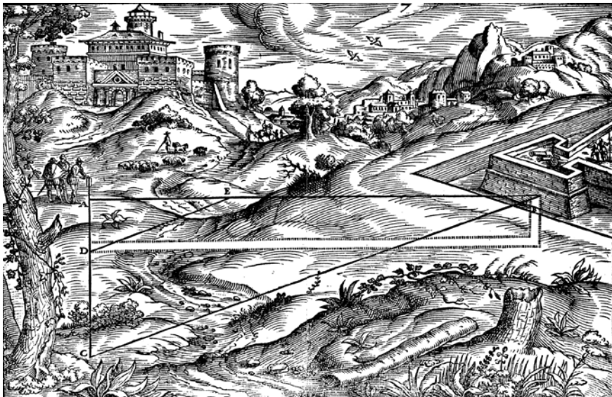
Figura 176 – Operações de minagem de muralhas (I) Fonte: Gabriello Busca (1585) Lançamento de um túnel de minagem com recurso à triangulação.
