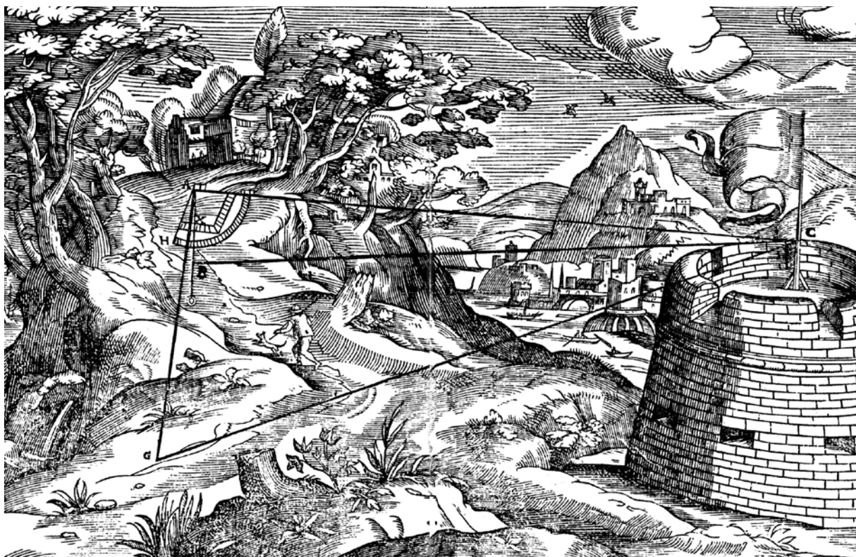
Figura 24 – Técnicas e instrumentos de medição (VIII): Cálculo da distância com o quadrante geométrico
